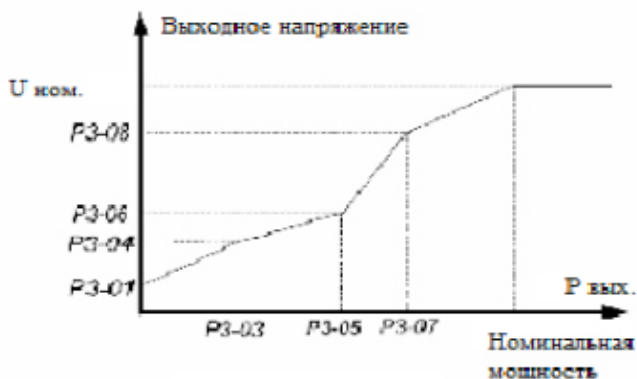
Рисунок 10. Каскадная кривая напряжения/частоты
