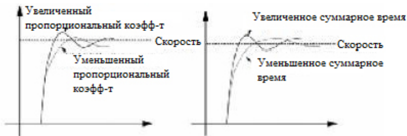
Рисунок 8. Параметры контура скорости P1
