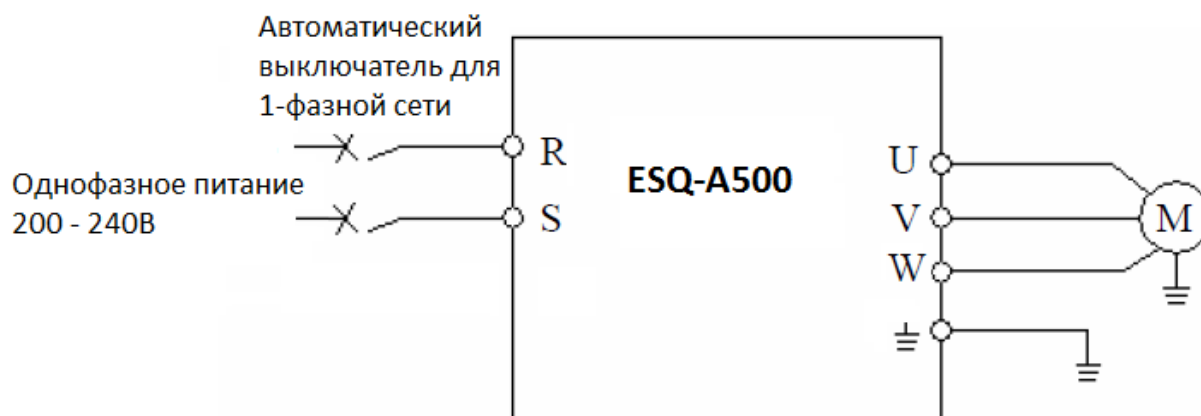
Рисунок 2. Однофазная схема подключения мотора к ЧП
