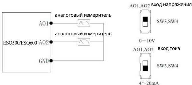
Рис.3-13 Схема монтажа клемм AO1,AO2
