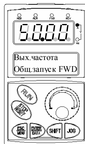
Рис.с Режим запуска, отобр. парам.режим.запуска
