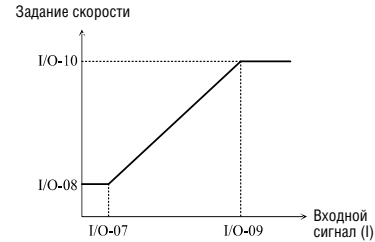
[Зависимость задания скорости/момента от входного сигнала (4 ÷ 20мА)]
